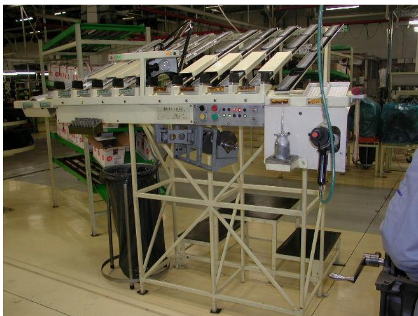
Dispozitiv electronizat (mobilă dinamică) pentru alegere semicuzineți motor
