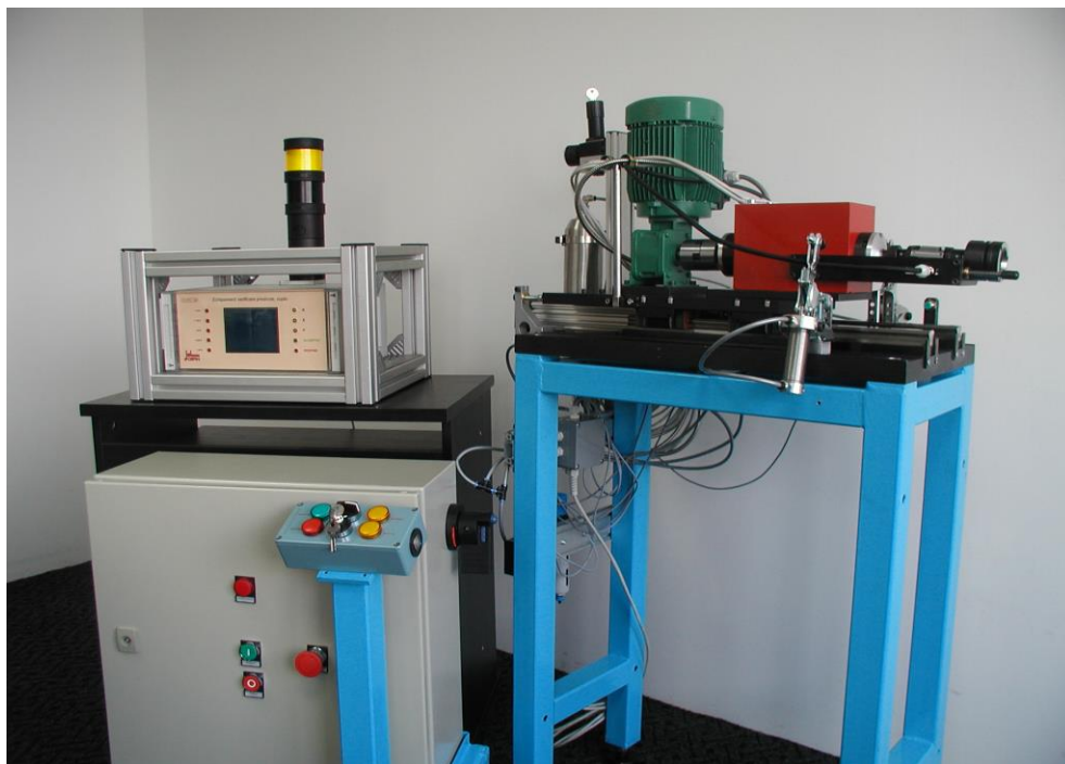
Echipament măsurare cuplu rezistent arbore motor
