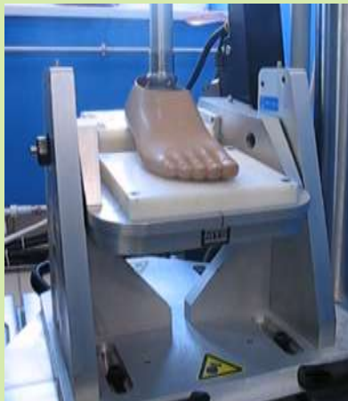
Testare subansamblul „gleznă-picior pentru proteză externă membru inferior”
