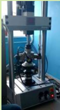
Simulare uzură endoproteză de șold
